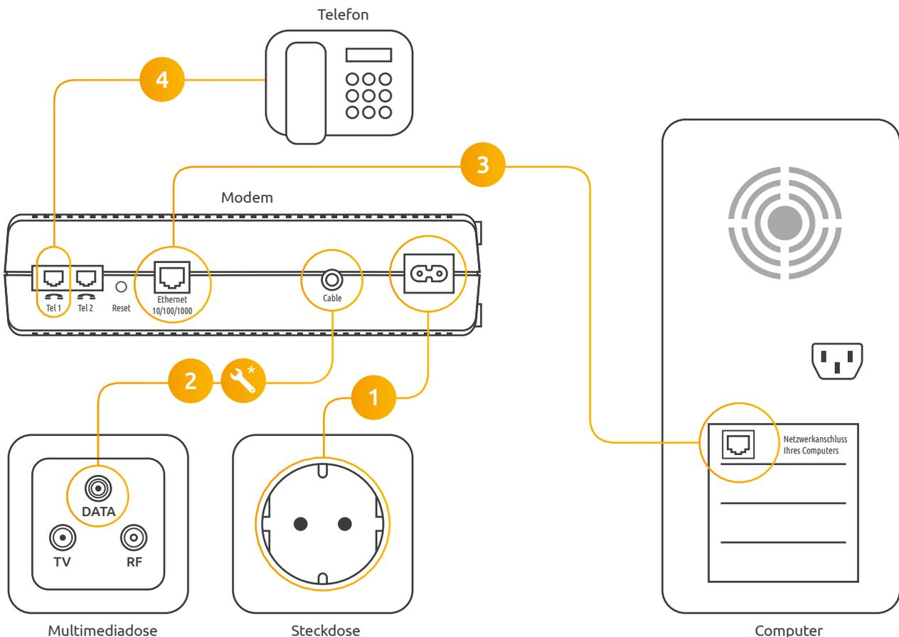
\* Die beiden F-Stecker am Antennenkabel müssen jeweils an der Multimediadose (DATA) und am Kabelmodem schlüsselfest angezogen werden.
