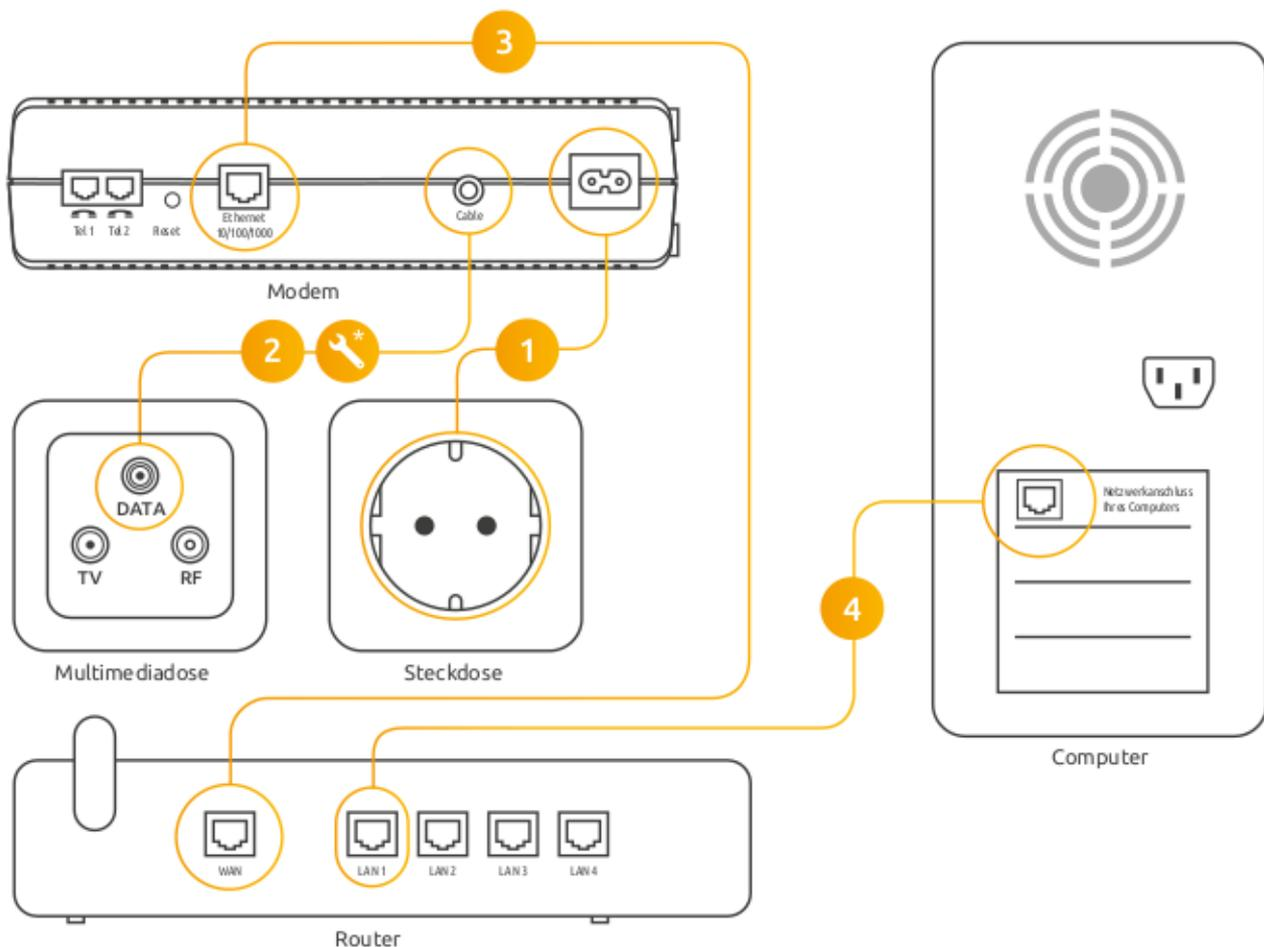
\* Die beiden F-Stecker am Antennenkabel müssen jeweils an der Multimediadose (DATA) und am Kabelmodem schlüsselfest angezogen werden.
