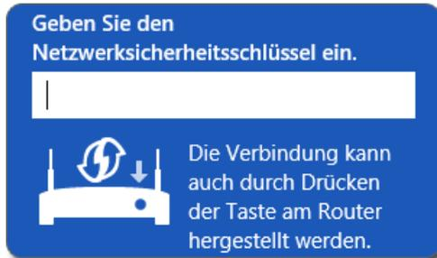
5. Für diesen Schritt haben Sie zwei Minuten Zeit: Drücken Sie an der FRITZ!Box so lange auf den Taster „WLAN“, bis die Leuchtdiode „WLAN“ blinkt.
