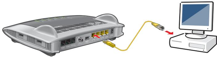
Anschluss eines Computers mit einem Netzwerkkabel
